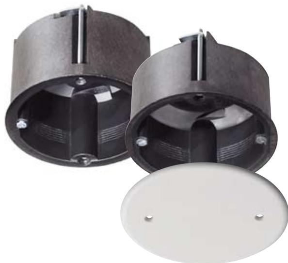
**Deckendose HWD 30** für sicheren Brandschutz von F 30 bis F 90. Der integrierte Dämmschichtbildner schäumt im Brandfall sofort auf und verschließt die Öffnung in der Decke. Auch in der nachträglichen Installation sorgt die Deckendose HWD 30 für Sicherheit.
