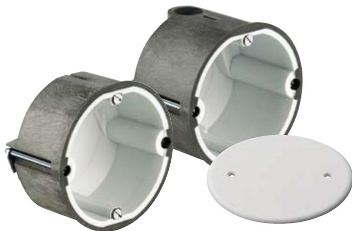
**Hohlwanddose HWD90 für F90 Brandschutzwände.** Die intelligente Technik reagiert sofort auf Feuer und Hitze und verschließt die Installationsöffnungen selbsttätig. Die Feuerwiderstandsklasse der Brandschutzwand ist damit gewährleistet, Fluchtwege gesichert und Menschenleben gerettet.
