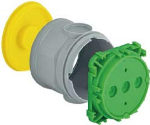
**Gerätedose und Geräte-Verbindungsdose** für die Installation in stehender Schalung. Ein modulares Programm mit 2- oder 3-teiligen Dosen, die mit flachen Frontteilen einfach auf die Schalung genagelt werden. Die besondere, flexible Bauweise sorgt für einen integrierten Federweg, der sicheren Halt zwischen den Schalungen bietet.
